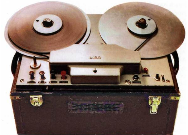
Bild 52: Das erste Tonbandgerät der Welt: K 1 von AEG. (nach Zierl, S.52)
